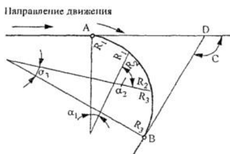
Рис. 8.3. Схема для расчета коробовой кривой
